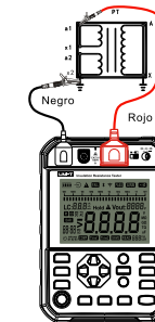
Fig. 10.2.3 Conexión de prueba
