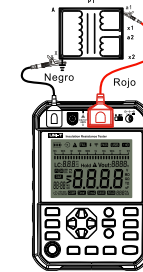
Fig. 10.2.2 Conexión de prueba
