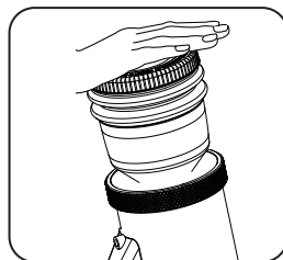
Βήμα 3 Τοποθέτησε το χέρι σου πάνω από το καπάκι του δοχείου με τους κόκκους καφέ πίεσε απαλά το καπάκι του δοχείου και φύσηξε τα υπολείμματα του αλεσμένου καφέ από τη συσκευή.
