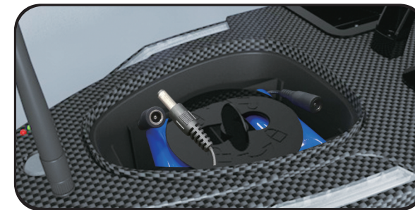
Σύνδεση συσσωρευτή Συνδέστε τη διασύνδεση του θαλάμου συσσωρευτή κατά τη χρήση
