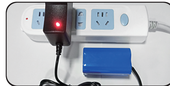
Διασύνδεση φόρτισης συσσωρευτή: Συνδέστε τον συσσωρευτή στον φορτιστή Κόκκινο φως: Φόρτιση Πράσινο φως: Ολοκληρωμένη φόρτιση
