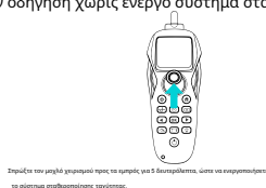
Πατήστε τον μοχλό χειρισμού προς τα εμπρός για 5 δευτερόλεπτα, ώστε να ενεργοποιηθεί το σύστημα σταθεροποίησης ταχύτητας.
